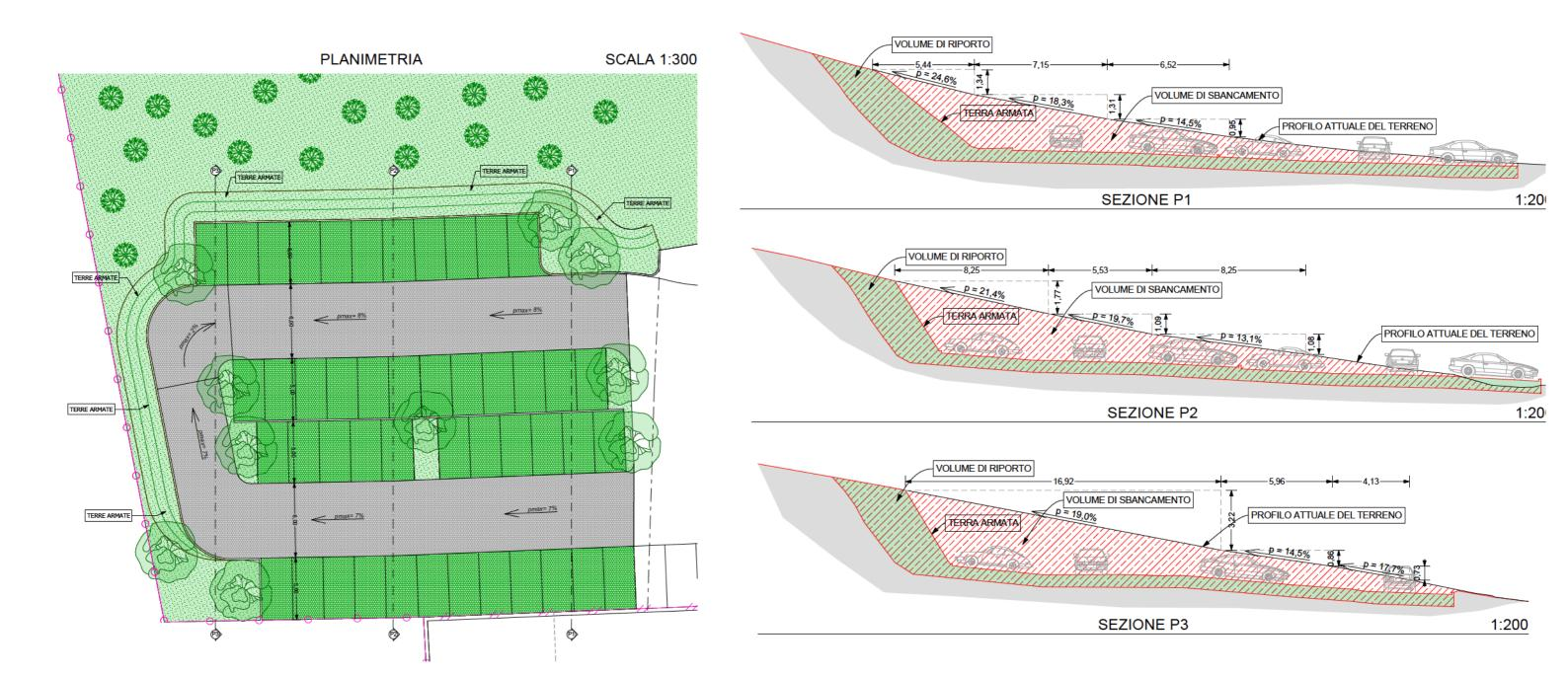
A SEGUITO DELLA STESURA DEL PIANO QUOTATO SU TUTTO IL VERSANTE RICADENTE ALL'INTERNO DEL COMPARTO UNITARIO, IN TUTTA LA ZONA IN CUI SI INTERVIENE CON LA REALIZZAZIONE DEL PARCHEGGIO, NON SI RISCONTRA UNA PENDENZA SUPERIORE O UGUALE AL 30%
