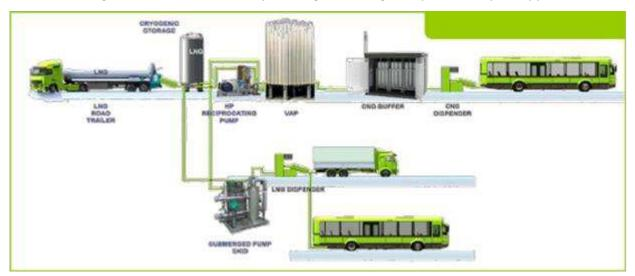
In particolare l'applicazione riguarda un impianto d'erogazione gas naturale compresso (LCNG) per auto-trazione, completo di stoccaggio, pompaggio e vaporizzazione, alimentato mediante liquido criogenico. L'impianto stesso prevede anche l'erogazione di gas naturale liquido (LNG) per consentire il rifornimento dei serbatoi criogenici dei mezzi pesanti.
