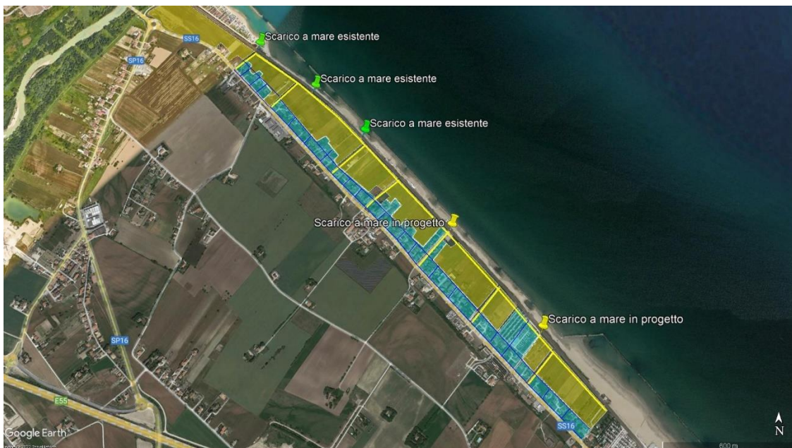
Figura 30 – Schema di massima per lo smaltimento delle acque meteoriche nell'area di indagine (in blu la rete capillare di collettamento delle acque meteoriche in area urbana, in giallo le direttrici di smaltimento verso il mare e il sistema di vasche di laminazione parallele alla costa atte a raccogliere e smaltire verso il mare le acque di pioggia drenate dall'area urbana e agricola)
