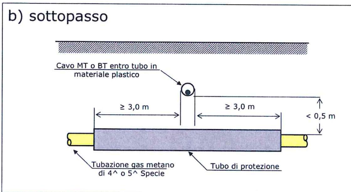
Incrocio tra cavidotti MT-BT e tubazioni del gas metano di 4ª e 5ª specie ( $\leq 5$  bar) a una distanza  $< 0,5$  m: a) sovrappasso; b) sottopasso
