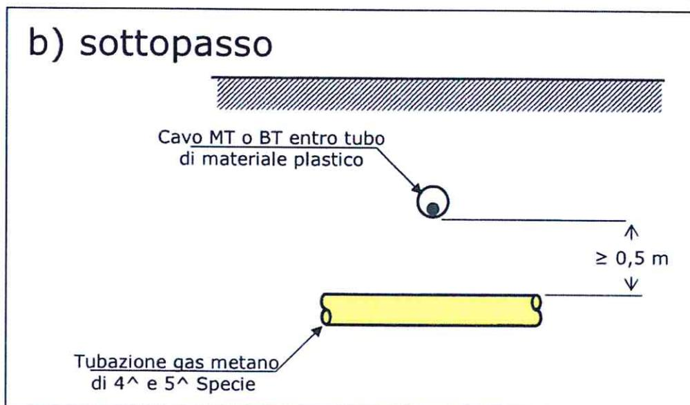
Incrocio tra cavidotti MT-BT e tubazioni del gas metano di 4<sup>a</sup> e 5<sup>a</sup> Specie ( $\leq 5$  bar) a una distanza  $\geq 0,5$  m
