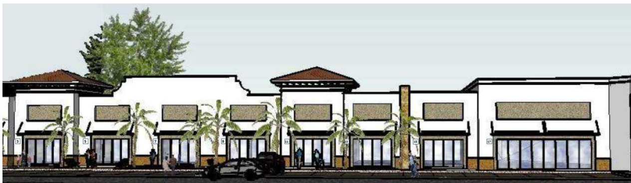
Figura 16 – Esempificazione di finestre partizionate utilizzate sia come accessi che come vetrine
