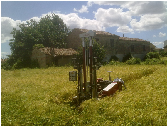
Foto postazione DPSH3
