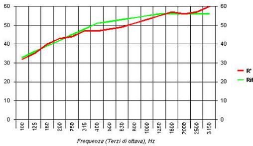
**Indice di valutazione del potere fonoisolante = 52 dB - Indice di valutazione dell'isolamento acustico = 52 dB**
