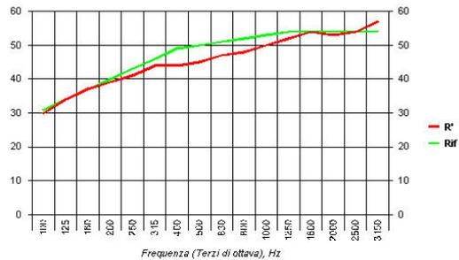
**Indice di valutazione del potere fonoisolante = 50 dB - Indice di valutazione dell'isolamento acustico = 50 dB**
