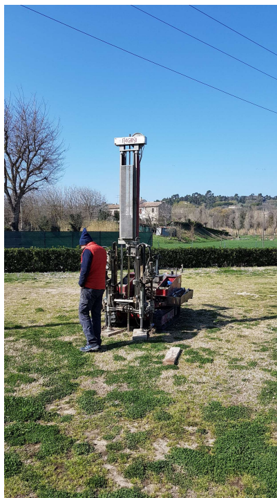
Postazione prova penetrometrica statica C.P.T.- 2
