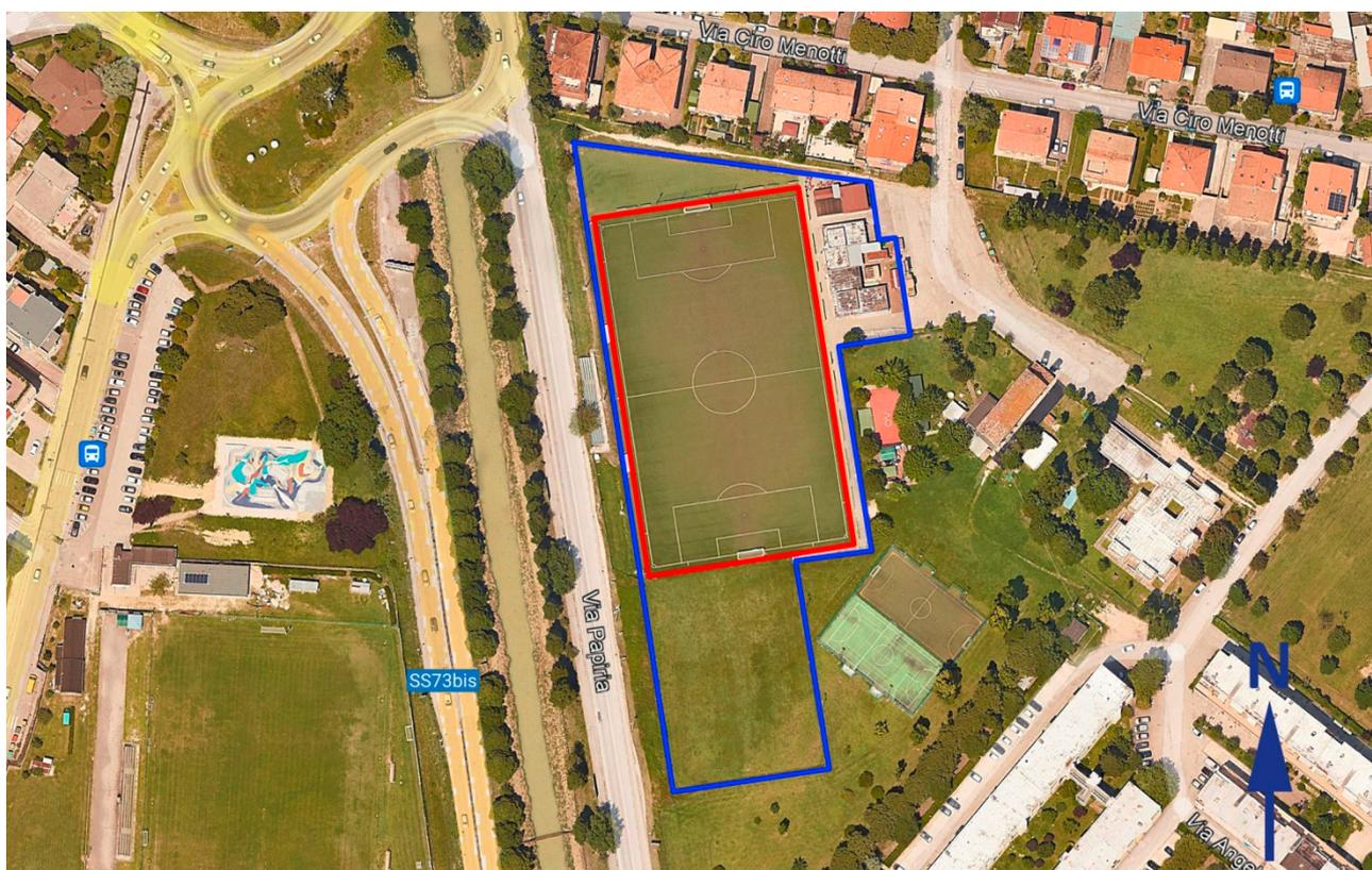
L'intervento consiste nella riqualificazione dell'impianto sportivo prevedendo la sostituzione del manto del campo principale in erba sintetica, in stato di degrado, con altro nuovo della stessa tipologia, regolamentare con omologazione da parte della Lega Nazionale Dilettanti (LND) per le categorie di giuoco fino all'Eccellenza.
