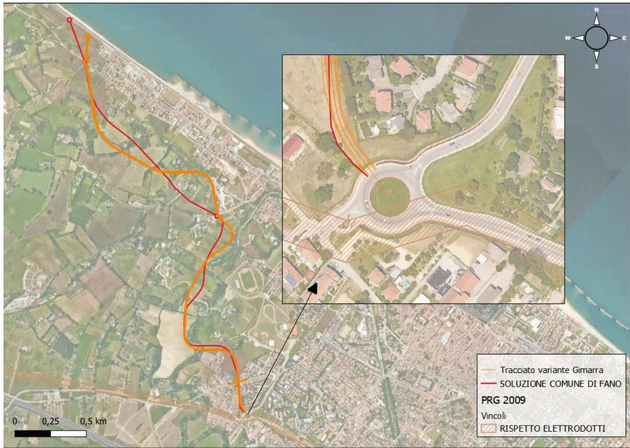
Figura 21 Fascia di rispetto elettrodotti. In arancione il tracciato di progetto e in rosso il tracciato previsto dal Comune di Fano.
