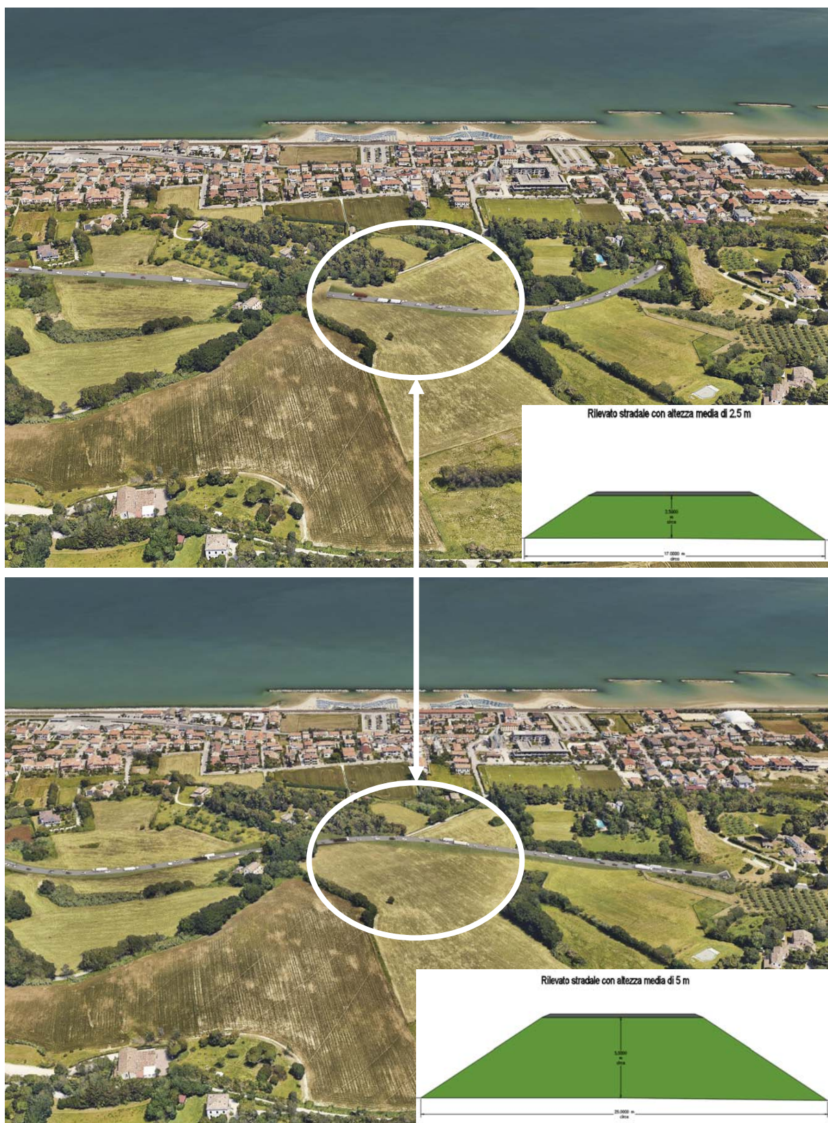
Figura 20: Raffronto a volo d'uccello tra le due proposte in prossimità dell'intersezione con Via di Villa S. Biagio
