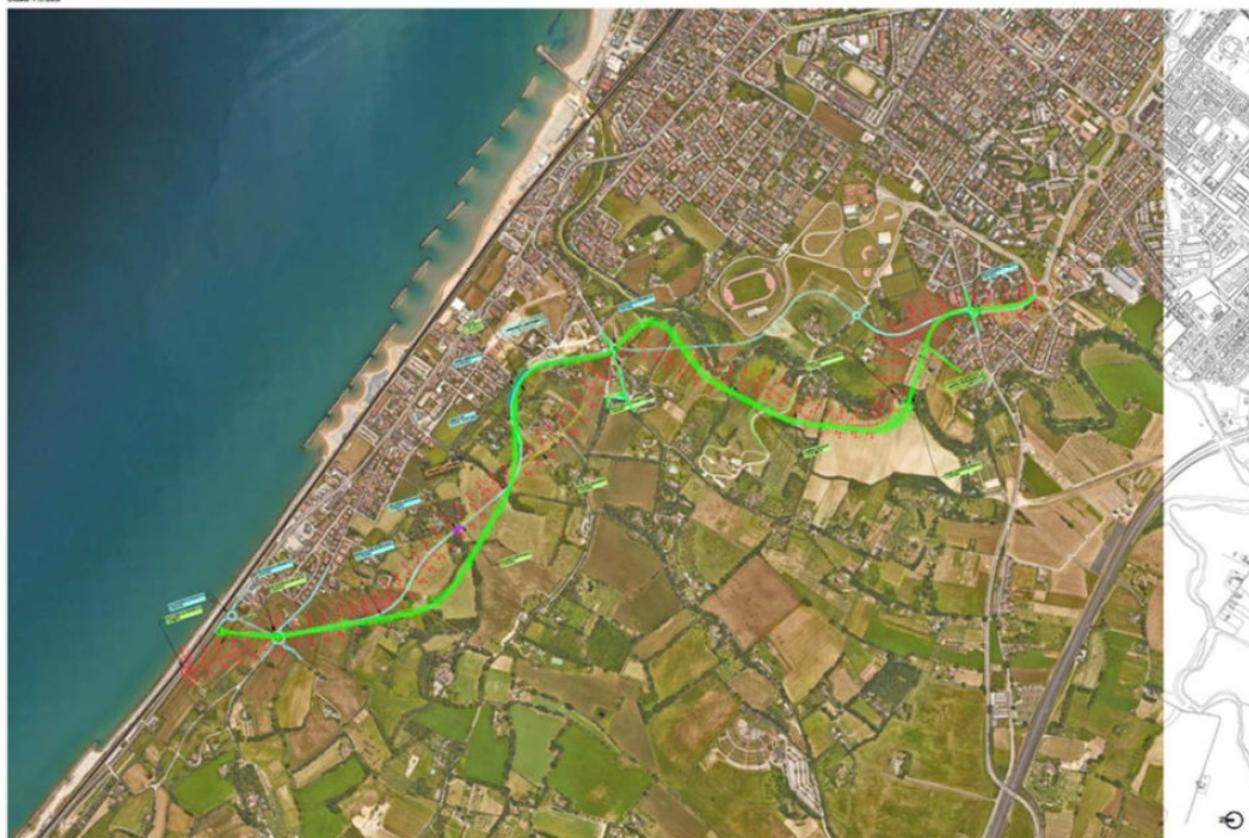
Figura 1-1: Tracciato per la prima parte della variante dell'attacco di Via Aldo Moro fino all'abitato di Gimarra
