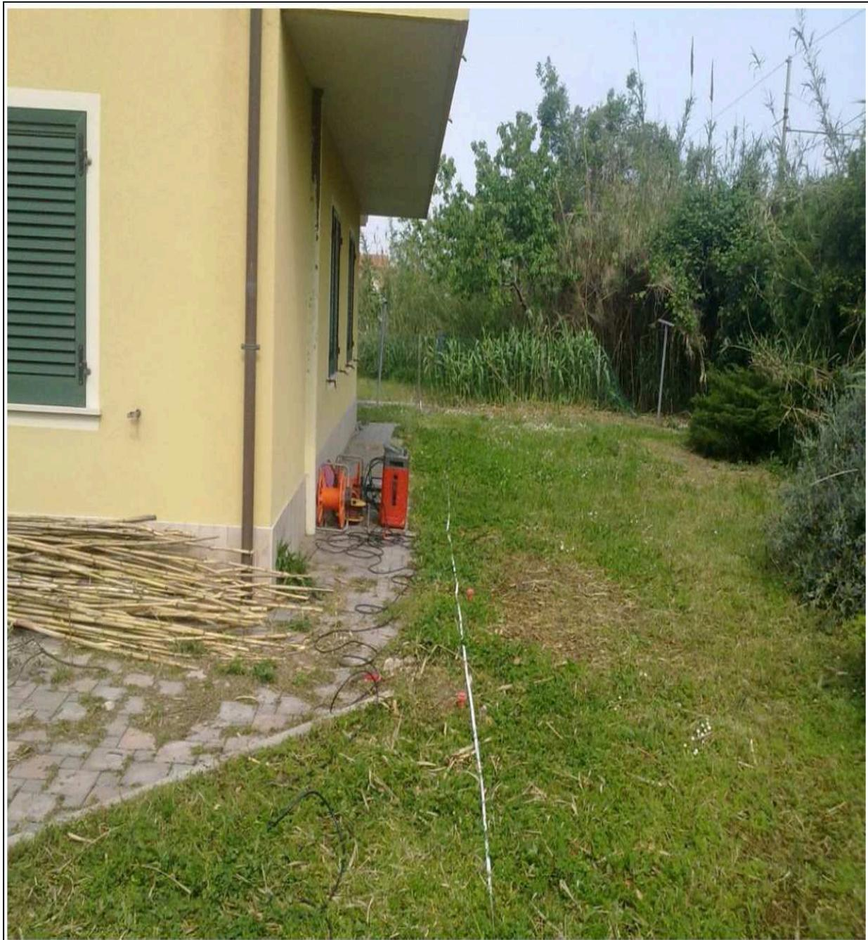
**Fig. 4F - Prova MASW ( Profilo della velocità delle onde sismiche di taglio Vs)**
