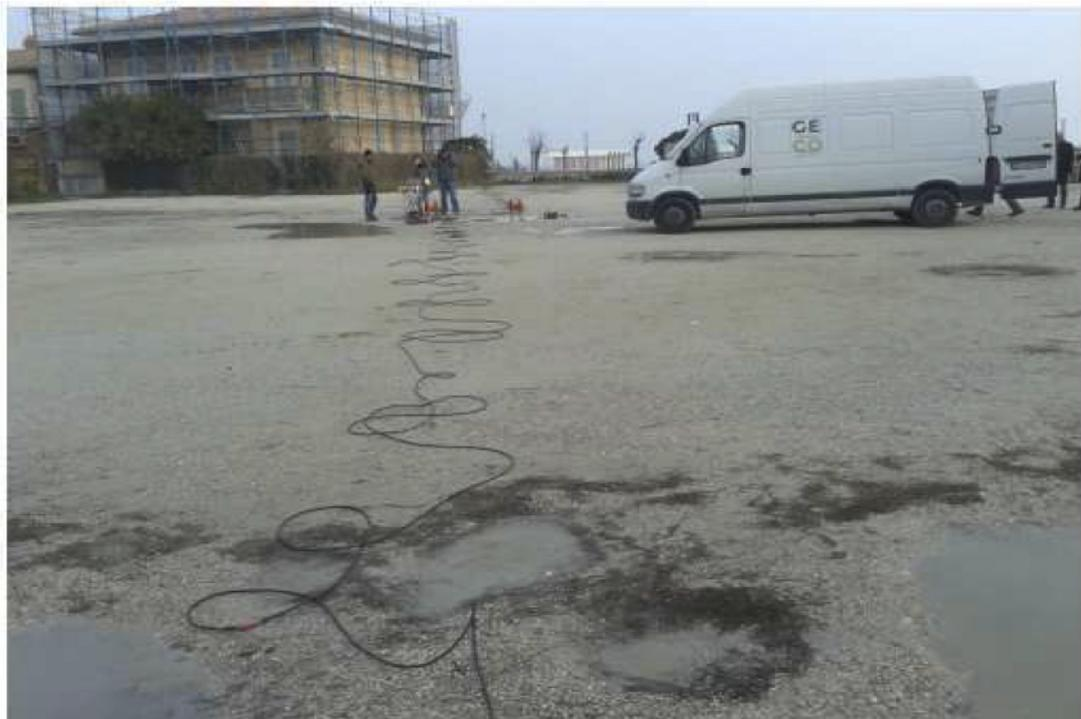
*Fig. 6.3.1 prova MASW sull'area "A"*
