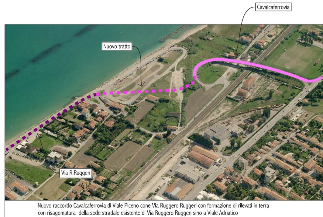
Nuovo raccordo Cavalcaferrovia di Viale Piceno con Via Ruggero Ruggeri con formazione di rilevati in terra con risagomatura della sede stradale esistente di Via Ruggero Ruggeri sino a Viale Adriatico
