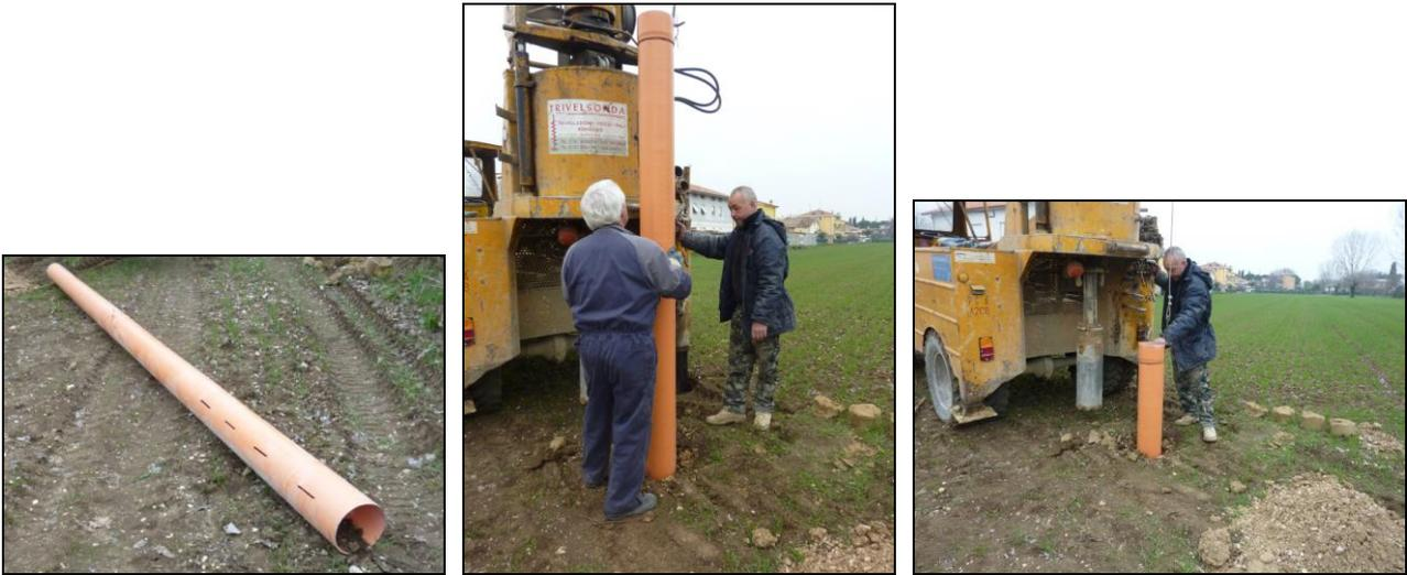
In data 03/04/2013 è stata valutata tramite l'esecuzione di una prova di permeabilità la capacità di assorbimento delle ghiaie all'interno del foro del sondaggio 4
