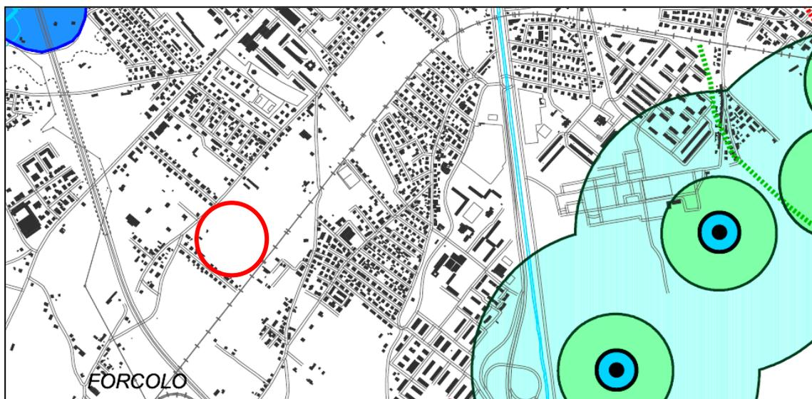
Per quanto riguarda l'idrografia profonda, dall'indagine di campagna eseguita mediante la misurazione di alcuni pozzi ubicati in un intorno significativo dell'area come da planimetria riportata di seguito (pag. 19), la falda idrica risulta ubicata all'interno del deposito alluvionale e il suo livello statico risulta essere alla profondità variabile tra 12.90 e 13.61 m. dal p.c.
